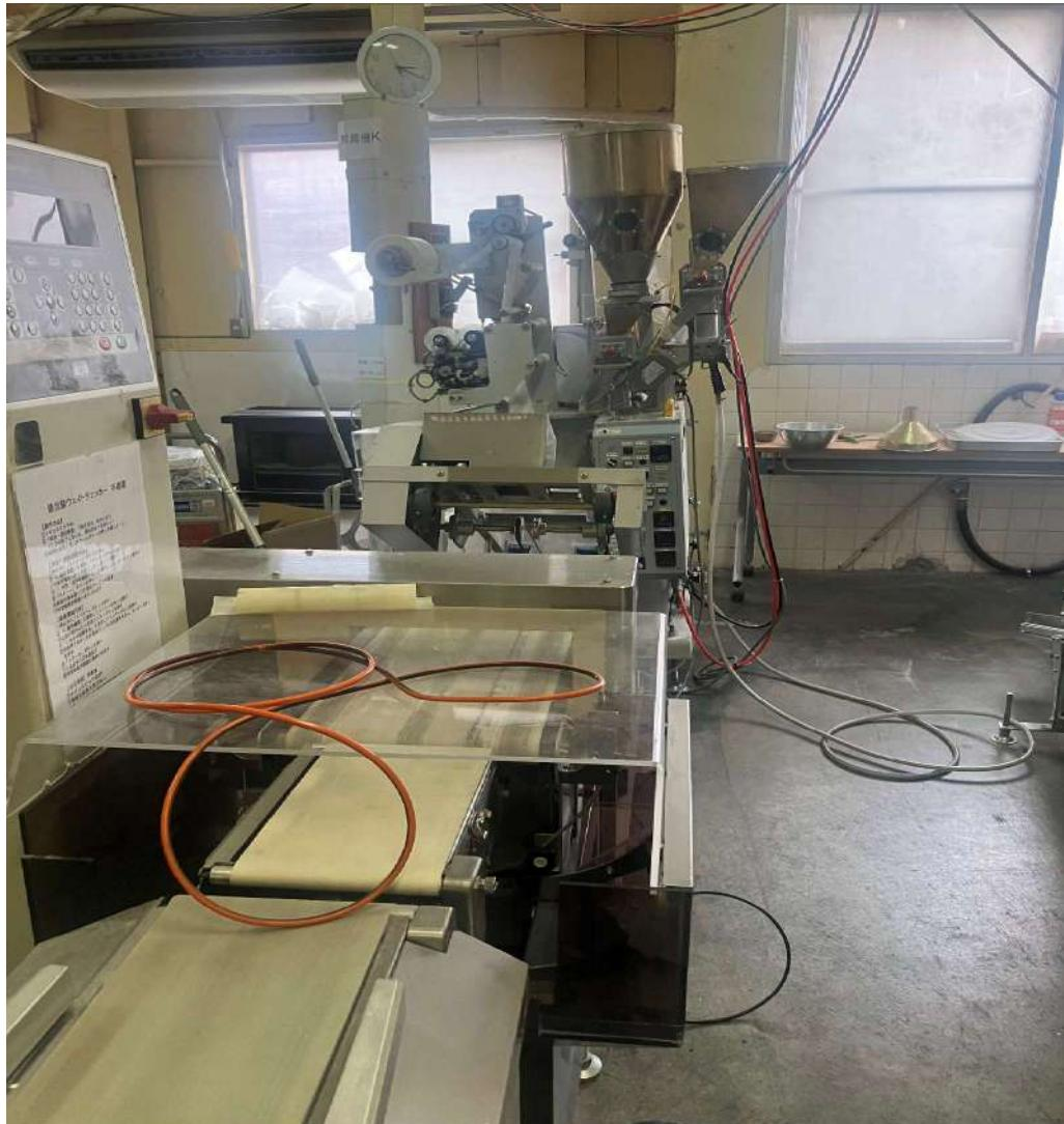
トパックN-360 合掌シール縦型製袋充填包装機
